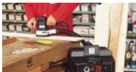
Τρίψιμο ξύλου με χρήση βιομηχανικού απορροφητήρα ISS 45-M με έγκριση για χρήση σε περιβάλλον σκόνης M.
